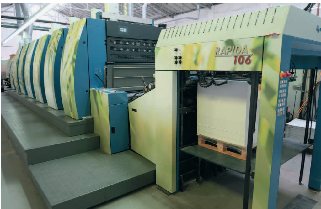
Gesetzte Wertschöpfung bei Königsdruck: die Bogenoffsetdruckmaschine KBA Rapida 106, ausgerüstet mit einem LED-UV-Trockner von AMS – Air Motion Systems.
